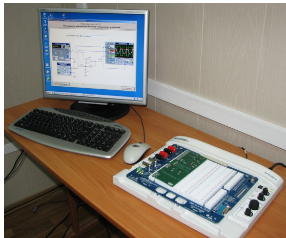
Лабораторные установки дистанционной лаборатории по курсам «Основы теории цепей» и «Радиотехнические цепи и сигналы» на базе измерительной станции NI ELVIS
