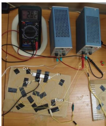
Рис. 7 – Схема подключения электрооптического ММЦ
