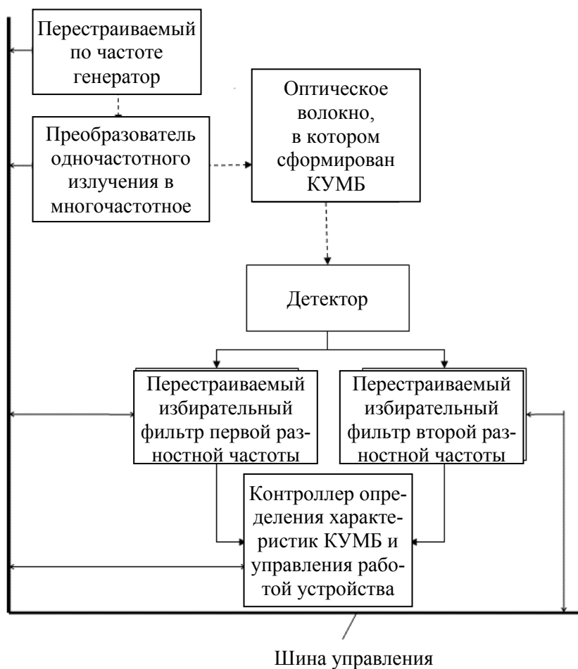
Рис. 5 – Структурная схема устройства для реализации полигармонического способа определения характеристик контура усиления Манделъштама-Бриллюэна
