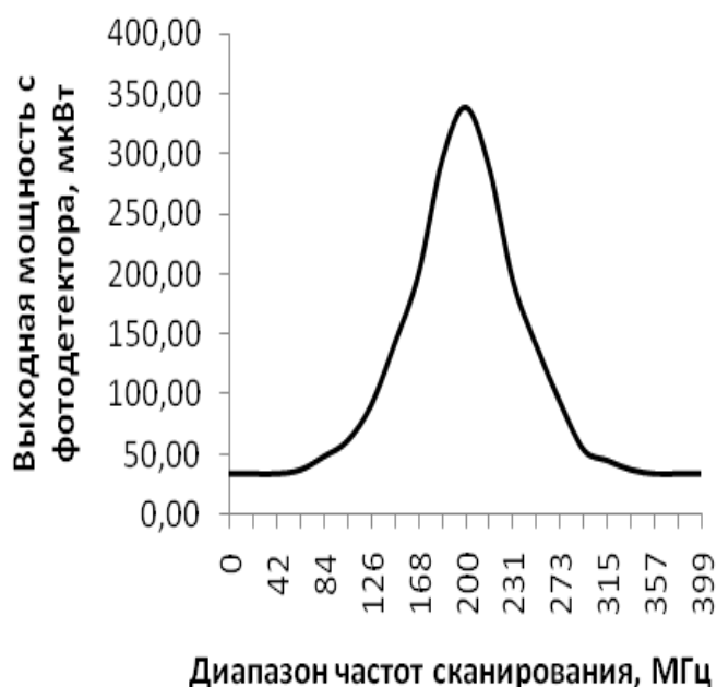
Рис.3 – Спектр КУМБ, полученный в результате моделирования
