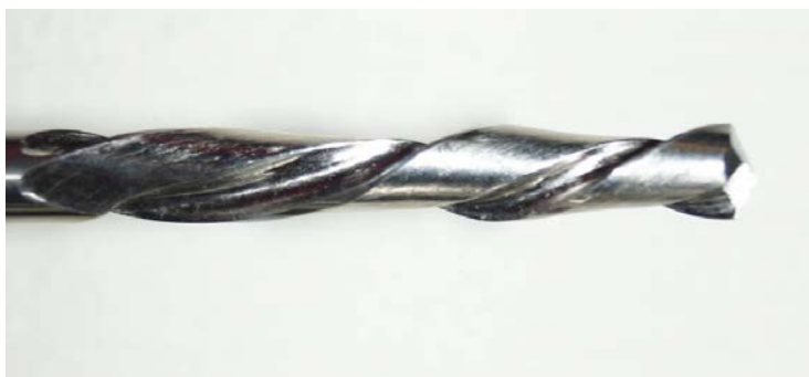
Рис. 17. Сверло с переменным углом наклона спирали
