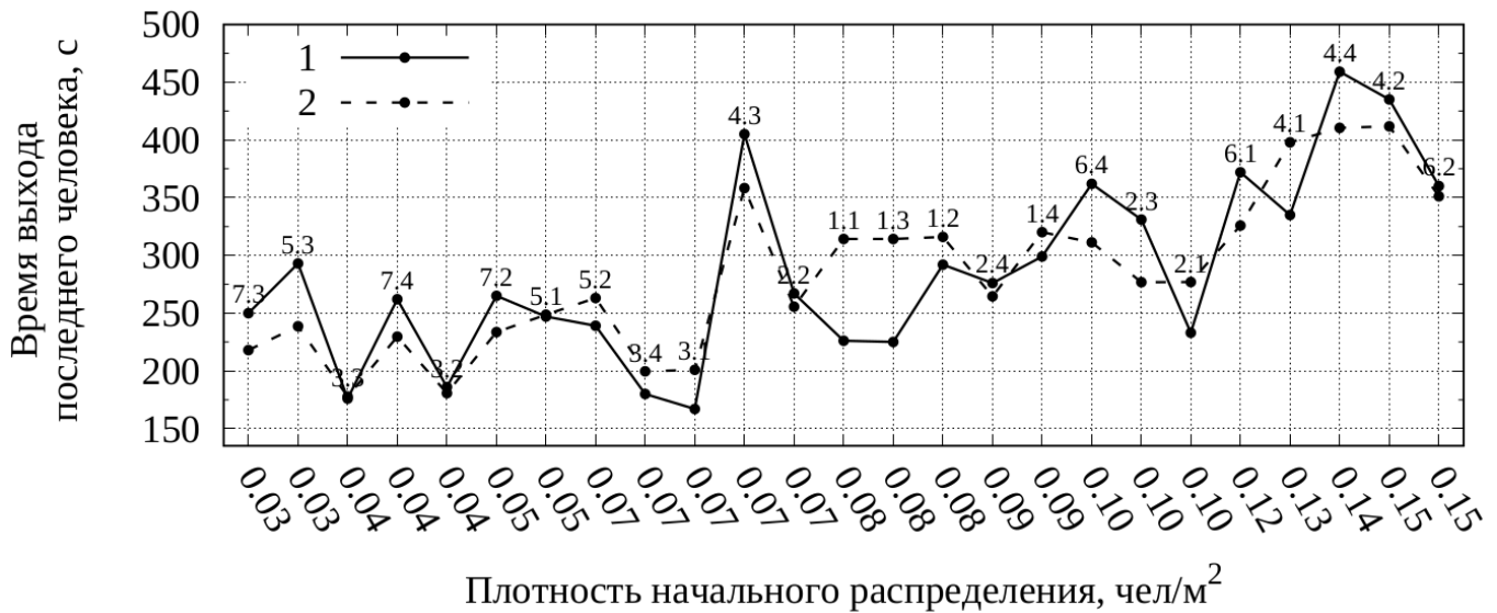
Рисунок 2 – Зависимость длительности освобождения здания от начальной плотности людского потока D : 1 – график, отвечающий экспериментальным данным, 2 – график отвечающий регрессионному уравнению (3)
