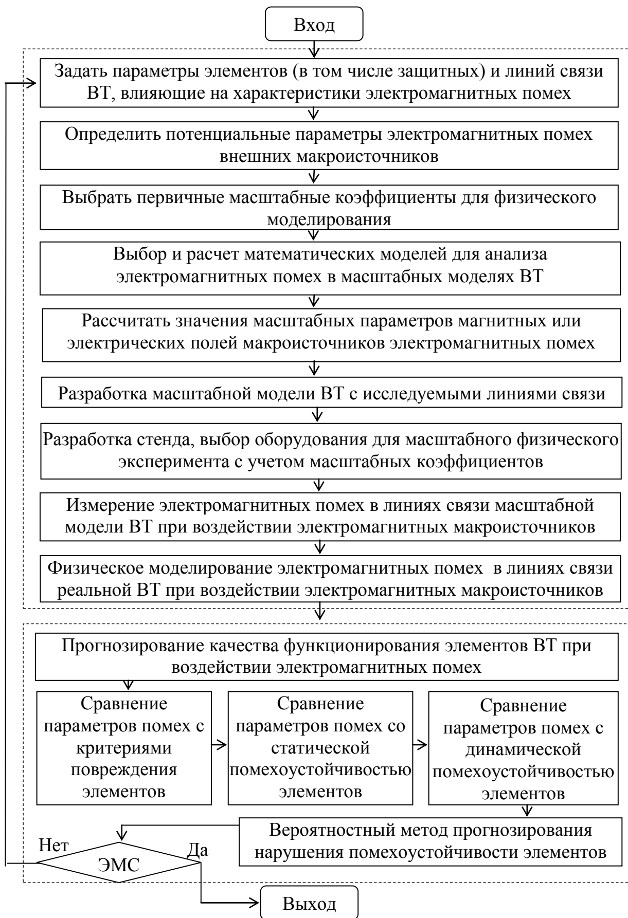
Рис. 1. Методика прогнозирования помехоустойчивости элементов ВТ на основе физического моделирования
