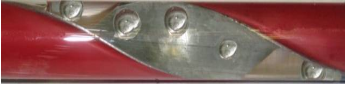
Рис. 1.2 — Фотографии пробкового режима течения в канале со скрученной лентой.
