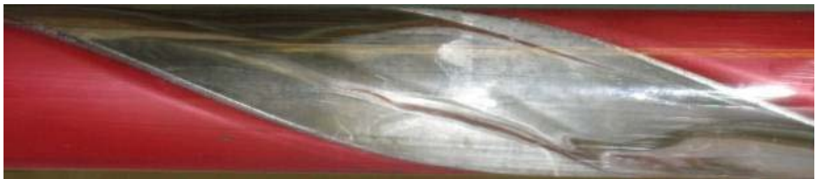
Рис. 1.3 — Фотографии волнового режима течения в канале со скрученной лентой.
