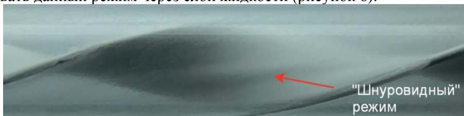
Рисунок 6. Фотография шнуровидного режима течения при кипении хладагента R134a в трубе со скрученной лентой при p=550 кПа
