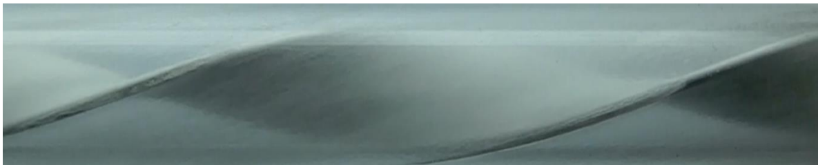
Рисунок 10. Фотография кольцевого режима течения при кипении хладагента R134a в трубе со вставленными гладкими скрученными лентами
