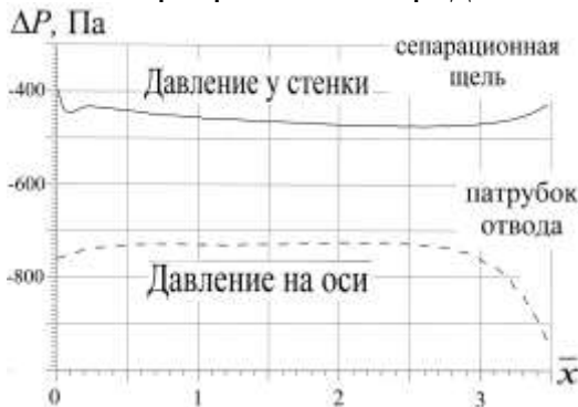
Рисунок 13. Продольные профили избыточного статического давления на оси и у стенки вихревой трубы
